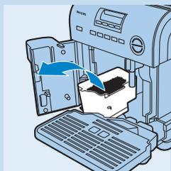
**3** Eemaldage tilganõu ning jäätmenõu ning puhastage need.
