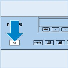
**1** Isključite aparat ali ostavite utikač u utičnici. Pričekajte dok se zaslon ne isključi.
