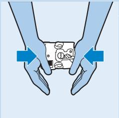
*Poznámka: Pokud se vám nedaří vložit varnou jednotku, pevně ji zároveň stiskněte shora a zdola a potom se ji pokuste vložit. Pokud se vám přesto nedaří varnou jednotku vložit, uzavřete obslužná dvířka, odpojte přístroj a pak ho znovu připojte. Počkejte, dokud po automatické kontrole nezhasnou všechny kontrolky a potom otevřete obslužná dvířka a vložte varnou jednotku zpět.*
