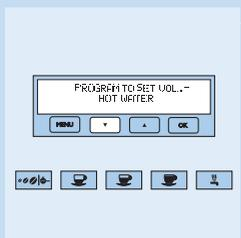
**3** Stiskněte tlačítko pro přípravu horké vody, dokud se na displeji nezobrazí zpráva ‚PROGRAM TO SET VOL - HOT WATER‘ (‚PROGRAM NASTAVENÍ OBJEMU - HORKÁ VODA‘). Potom tlačítko uvolněte.
