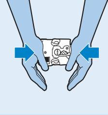
*Notă: Dacă nu puteți introduce unitatea de preparare, apăsați-o ferm din părțile superioară și inferioară în același timp, apoi încercați să o introduceți. Dacă în continuare nu puteți să o introduceți, închideți ușa de service, deconectați aparatul de la priză și reconectați-l. Așteptați stingerea tuturor indicatoarelor după verificarea automată, apoi deschideți ușa de service și reintroduceți unitatea de preparare.*
