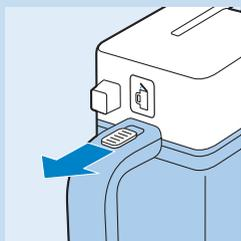
**1** Posuňte uvolňovací posuvné tlačítko směrem k sobě a sejměte víko džbánu na mléko.
