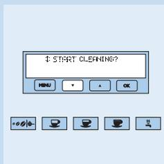
**2** Pritiskajte gumb ▼, dokler se na zaslonu ne prikaže sporočilo “START CLEANING?” (ZAČETEK ČIŠČENJA?).
