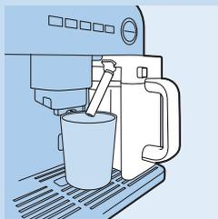
**6** Atașați vasul pentru lapte la duză. Amplasați o ceașcă suficient de mare sub gura de scurgere a cafelei și deplasați tubul pentru lapte înspre ceașcă.
