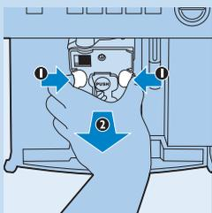
*Piezīme. Pagatavošanas bloku var izņemt tikai tad, ja ierīce ir izslēgta. Mēģinot izņemt pagatavošanas bloku, kamēr ierīce ir ieslēgta, var rasties nopietni bojājumi.*
