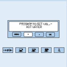
**3** Nyomja meg a forró víz gombját, míg a „PROGRAM TO SET VOL - HOT WATER” (MENNYISÉG PROGRAMOZÁSA - FORRÓ VÍZ) üzenet meg nem jelenik a kijelzőn.
