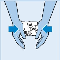
*Piezīme.* Ja nevarat ievietot pagatavošanas bloku, vienlaikus nedaudz saspiediet to no augšpusē un lejasdaļas un pēc tam vēlreiz mēģiniet to ievietot. Ja pagatavošanas bloku vēl joprojām nevar ievietot, aizveriet apkopes vāku, atvienojiet ierīci no elektrotīkla un pēc tam pieslēdziet to atpakaļ. Pagaidiet, līdz pēc pašpārbaudes izdziest visi indikatori, un pēc tam atveriet apkopes vāku un ievietojiet pagatavošanas bloku atpakaļ.
