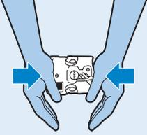
*Pastaba: Jei negalite įdėti virimo įrenginio, tuo pačiu metu tvirtai paspauskite įrenginį į viršų ir apačią ir tada pabandykite įdėti. Jei vis tiek negalite įdėti virimo įrenginio, uždarykite eksploatavimo dangtelį, išjunkite prietaisą ir vėl įjunkite. Palaukite, kol visos lemputės užges po savikontrolės, tada atidarykite eksploatavimo dangtelį ir iš naujo įdėkite virimo įrenginį.*
