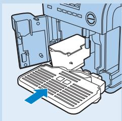
4 Įstumkite atliekų konteinerį atgal, įdėkite nuvarvėjimo padėklą ir uždarykite dureles.
