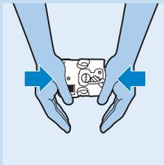
*Poznámka: Ak sa Vám nedarí vložiť varnú jednotku, pevne stlačte jednotku súčasne zhora a zdola a potom ju skúste vložiť. Ak aj napriek tomu nedokázate vložiť varnú jednotku, zatvorte servisné dverka, odpojte zariadenie a potom ho znova zapojte. Počkajte, kým po automatickej kontrole zhasnú všetky kontrolné svetlá, potom otvorte servisné dverka a vložte varnú jednotku.*
