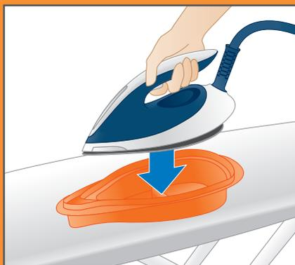
Coloque la plancha sobre el recipiente de eliminación de la cal en una superficie uniforme y estable.
