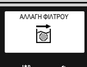
Ενδειξη μηχανής ότι πρέπει ν' αντικατασταθεί το φίλτρο νερού «INTENZA+».
