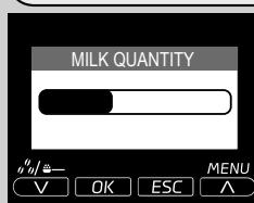
Z reguliranjem kazalnika na zaslonu s tipkami za listanje "V" ali "A" lahko izberete količino mleka pri točenju izbranega napitka. Pritisnite OK za potrditev nastavitev.
