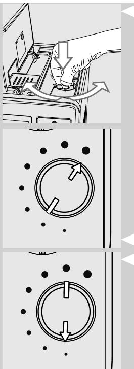
**2** Pritisnite in obračajte gumb za nastavitev mletja po posamičnih preskokih. Razliko v okusu boste lahko zaznali po 2-3 iztočenih ekspres kavah.
