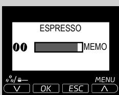
**2** Držite stisnjeno tipko "ESPRESSO", dokler se ne prikaže simbol "MEMO". Spustite tipko. Sedaj se aparat programira. Aparat prične točiti kavo.
