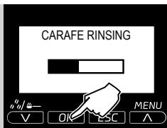
**16** Aparat začne točiti vodo tako iz pipe za točenje kave, kot tudi iz pipe za točenje mleka. Kazalnik omogoča spremljanje napredovanja postopka.
