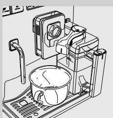
**1** Vrč z mlekom vstavite v aparat in postavite skodelico pod pipo za točenje. Pipo za točenje mleka odprite z zasukom v levo.
