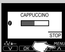
**7** Ko se prikaže naslednji zaslon, aparat sproži točenje penjenega mleka. Za predhodno prekinitev točenja pritisnite tipko "MENU".
