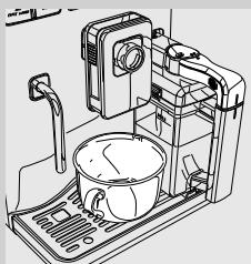
**2** Pod pipo za točenje namestite skodelico in odprite pipo za točenje v vrču tako, da jo zasukate v desno.
