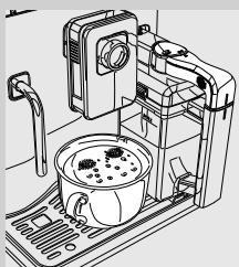
**4** Po končanem točenju mlečne pene, aparat iztoči kavo. Za predhodno prekinitev točenja pritisnite tipko "V".
