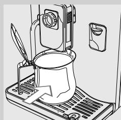
**6** Pod pipa za točenje kave postavite posodo (1,5 l).
