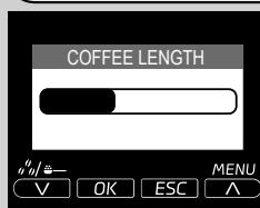
Z reguliranjem kazalnika na zaslonu s tipkami za listanje "V" ali "A" lahko izberete količino vode pri točenju kave.
