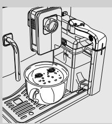
**9** Odstranite skodelico in zaprite pipo za točenje mleka v levo.
