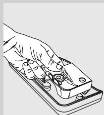
**4** Izvlecite nosilec pod rešetko. Operite nosilec in pladenj za zbiranje tekočin.
