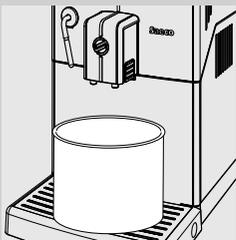
**6** Colocar un recipiente grande (1,5 l) bajo el tubo de vapor/agua caliente y bajo la salida de café.
