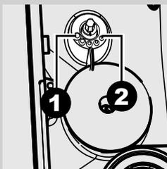
**3** Las referencias presentes en el interior del contenedor de café en grano indican el grado de molido configurado. Es posible configurar 5 grados de molido distintos, de la posición 1 (●), para un molido grueso y un sabor más suave, a la posición 2 (◐), para un molido fino y un sabor más fuerte. Si el café está acuoso o sale con lentitud, modificar la configuración del molinillo de café.
