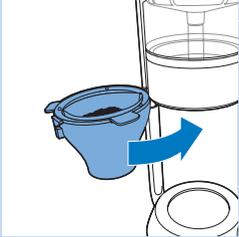
**7** Schließen Sie den Schwenkfilter.
