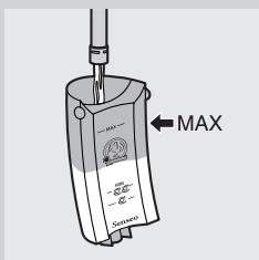
**1** Täytä vesisäiliö **MAX**-merkkiin asti kylmällä vedellä ja aseta vesisäiliö takaisin laitteeseen.
