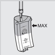
**1** Fyll vattenbehållaren med kallt vatten upp till **MAX**-markeringen och sätt tillbaka den på apparaten.
