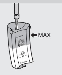
2 Fyll vattenbehållaren med kallt vatten upp till **MAX**-markeringen och sätt tillbaka den på apparaten.
