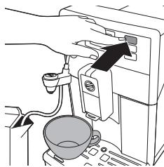
4 Τοποθετήστε ένα φλιτζάνι κάτω από το αυτόματο εξάρτημα για αφρόγαλα και πατήστε το κουμπί MILK FROTH (Αφρόγαλα).
