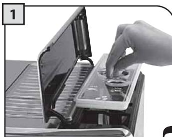
Podignite vanjski desni poklopac i uklonite unutarnji poklopac.
