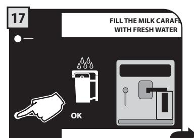
Uklonite vrč, isperite ga i napunite svježom pitkom vodom. Potvrdite pritiskom na tipku "OK".
