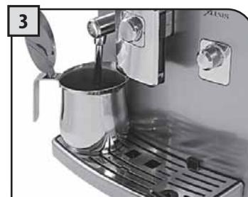
Ovaj je postupak moguće prekinuti pritiskom na "STOP STEAM". Na kraju postupka, izvucite spremnik sa zagrijanim napitkom.
