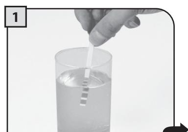
Umetnute u vodu, na 1 sekundu, test za utvrđivanje tvrdoće vode koja se nalazi u aparatu.
