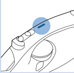
Қауіпсіздік үшін автоматты түрде өшіру табанында тұрып 30 секунд бойы пайдаланылмаса немесе артқы тақтасында тұрып 8 минут бойы пайдаланылмаса үтікті автоматты түрде өшіреді. Автоматты өшіру шамы жанады.
