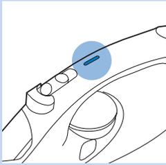
Функція безпечного автоматичного вимкнення автоматично вимикає праску, якщо нею не користувалися протягом 30 секунд (коли вона стоїть на підшві) або протягом 8 хвилин (коли вона стоїть на п'яті). Засвітиться індикатор автоматичного вимкнення.
