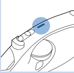
Ütü, tabanına yerleştirilmiş durumdayken 30 saniye veya arka kısmı üzerine yerleştirilmiş durumdayken 8 dakika boyunca çalışmadığında güvenli otomatik kapanma fonksiyonu ütüyü otomatik olarak kapatır. Otomatik kapanma ışığı yanar.
