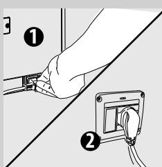
**10** Introduza a ficha na tomada de corrente posicionada na parte traseira da máquina.
