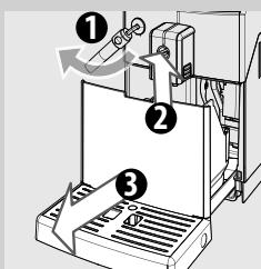
**16** Para limpar a bandeja de limpeza, coloque no interior da bandeja uma pastilha desengordurante e encha-a até 2/3 com água quente. Deixe a solução de limpeza actuar durante cerca de 30 minutos e, em seguida enxagúe abundantemente.
