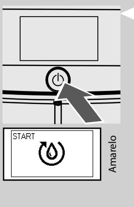
**13** Para ligar a máquina basta pressionar a tecla "". O painel de comando indica que é necessário proceder ao carregamento do circuito.
