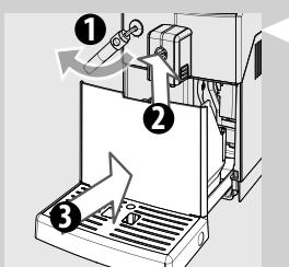
**4** Volte a introduzir a gaveta de recolha das borras na bandeja de limpeza e volte a colocar esta última na máquina.
