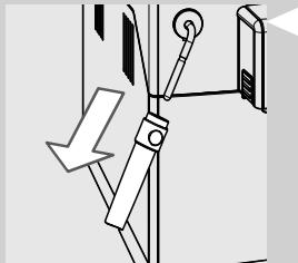
Depois de efectuar a espuma com o leite, é necessário distribuir uma pequena quantidade de água quente num recipiente.
