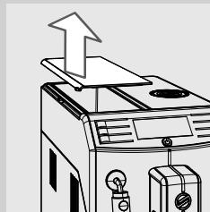
**4** Levante o reservatório de água utilizando a pega.
