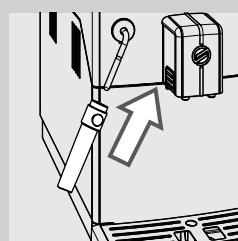
**17** Quando o reservatório da água estiver vazio, extraia-o, enxagúe-o e volte a enchê-lo com água fresca até ao nível MÁX. Reintroduza-o na máquina.
