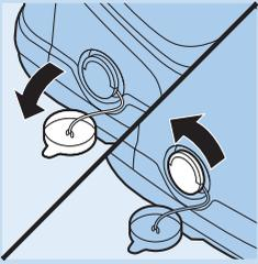
**3** Buka sirip bilasan Calc-Clean yang menutupi tutup bilasan Calc-Clean. Putar tutup bilasan Calc-Clean berlawanan arah jarum jam dan lepaskan.
