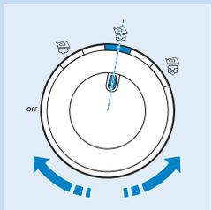
**8** 将电源旋钮旋转至所需的蒸汽设定，以启动产品。确保蒸汽设定适合选定的熨烫温度。
