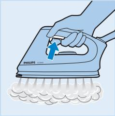
**9** 按下蒸汽觸動器，並在進行蒸汽熨燙時，繼續按住。如果熨燙時不要蒸汽，請直接使用熨斗，不要按下蒸汽觸動器即可。
