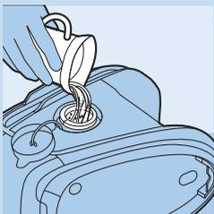
**5** เติมน้ำสะอาดลงในเครื่องทำไอน้ำ เขย่า แล้วเทน้ำลงในอ่างน้ำอีกครั้ง
