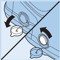
**3** เปิดฝาพับปิดส่วนขจัดตะกรันที่ครอบฝาปิดส่วนขจัดตะกรันไว้ หมุนฝาปิดส่วนขจัดตะกรันในทิศทางทวนเข็มนาฬิกา แล้วถอดออก
