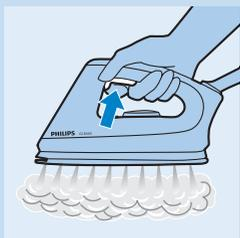
**9** 进行蒸汽熨烫时，应一直按住蒸汽开关。要进行无蒸汽熨烫，在使用熨斗时不按蒸汽开关即可。
