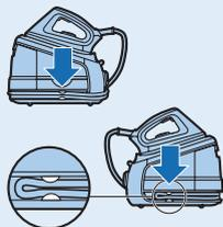
7 将蒸汽输送管绕在底部，并固定在储藏钩内。
