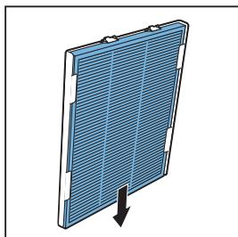
**8** Установите фильтр предварительной очистки обратно в прибор.
