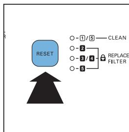
После замены фильтра обнулите показания счетчика фильтра:
