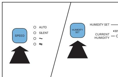
На очистителе воздуха дважды раздается звуковой сигнал, начнет мигать индикатор скорости работы вентилятора (~), указывающий на текущий уровень чувствительности датчика качества воздуха.
