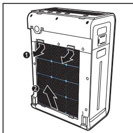
**4** Извлеките NANOфильтр из фильтра предварительной очистки.
