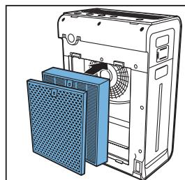
**6** Вставьте NANOфильтр (при его наличии) в фильтр предварительной очистки.
