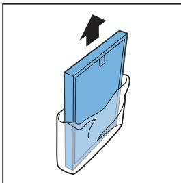
**8** Установите фильтр предварительной очистки в прибор.
