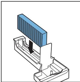
**3** Извлеките из прибора поддон увлажняющего фильтра.
