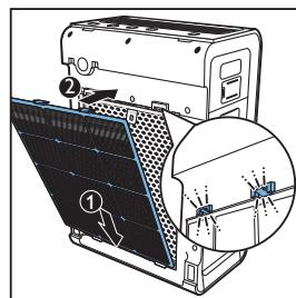
**9** Чтобы установить на место переднюю панель, сначала вставьте в верхнюю часть прибора верхние крючки (1). Затем прижмите панель к корпусу прибора (2).
