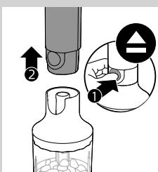
**8** Pritisnite dugme za otpuštanje da biste uklonili jedinicu motora sa poklopca seckalice.
