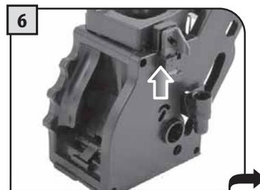
6 Proverite da li su sastavni delovi u pravilnom položaju. Prikazana kuka mora biti u pravilnom položaju; za potvrdu, pritisnite taster "PUSH".
