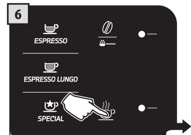
Pritisnite taster i sačekajte da iscuri programirana količina. Ovaj proces se može prekinuti pritiskom na "STOP HOT WATER".
