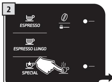
2 Pritisnite taster i sačekajte da iscuri programirana količina. Ovaj proces se može prekinuti pritiskom na "STOP HOT WATER".
