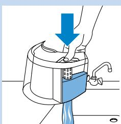
**4** Наповніть резервуар для води свіжою водою і встановіть його на генератор пари.
