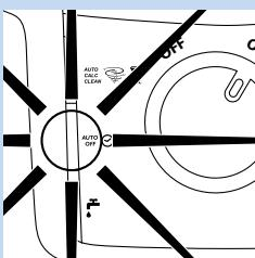
**Notă:** Dacă nu utilizați fierul de călcat mai mult de 10 minute, aparatul se oprește automat, din motive de siguranță. Lumina pentru oprire automată clipește. Pentru a porni din nou aparatul, apăsați orice buton.
