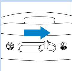
**4** Сдвиньте переключатель блокировки вправо для блокирования утюга на парогенераторе.
