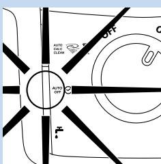
**Poznámka:** Ak žehličku nepoužívate dlhšie ako 10 minút, zariadenie sa z bezpečnostných dôvodov automaticky vypne. Ukazovateľ automatického vypnutia bliká. Ak chcete zariadenie znova zapnúť, stlačte ľubovolné tlačidlo.
