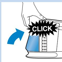
**4 Pripildykite vandens bakelį ir vėl jį pritvirtinkite prie garų generatoriaus.**
