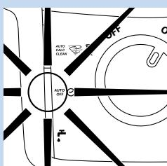
**Poznámka:** Pokud žehličku nepoužíváte déle než 10 minut, přístroj se z bezpečnostních důvodů automaticky vypne. Kontrolka automatického vypnutí začne blikat. Chcete-li přístroj znova zapnout, stiskněte jakékoli tlačítko.
