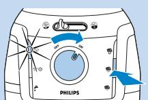
**3 Za ručno pokretanje postupka Calc Clean držite gumb za odabir pare u srednjem položaju istovremeno uključujući aparat. Gumb za odabir pare otpustite tek kad plavi indikator Auto Calc Clean počne treperiti.**
