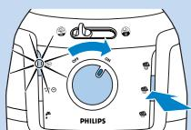
**3** Pentru a începe procesul de detartrare manuală, mențineți apăsat butonul de selectare medie a aburului, în timp ce porniți aparatul. Eliberați butonul de selectare a aburului numai când lumina albastră pentru detartrare automată clipește.
