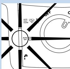
**Piezīme:** Ja nelietojat gludekļi vairāk par 10 minūtēm, ierīce drošības iemeslu dēļ automātiski izslēdzās. Mirgo automātiskās izslēgšanās lampiņa. Lai no jauna ieslēgtu ierīci, nospiediet jebkuru pogu.
