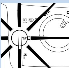
**Napomena:** Ako glačalo ne koristite više od 10 minuta, automatski se isključuje iz sigurnosnih razloga. Indikator automatskog isključivanja treperi. Kako biste ponovo uključili aparat, pritisnite bilo koji gumb.
