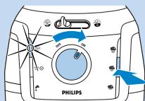
**3** Щоб запустити процес очищення Calc Clean вручну, натисніть і утримуйте кнопку вибору середнього налаштування пари, одночасно вмикаючи пристрій. Відпустіть кнопку вибору пари після того, як почне блимати блакитний індикатор автоматичної функції Calc Clean.
