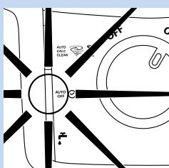
**Opomba:** Če likalnika ne uporabljate dlje kot 10 minut, se iz varnostnih razlogov samodejno izklopi. Indikator za samodejni izklop utripa. Če aparat želite ponovno vklopliti, pritisnite katerikoli gumb.
