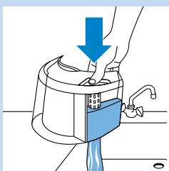
**4** Наполните емкость для воды и установите ее в парогенератор.
