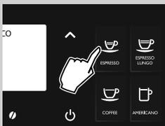
**9** Ispuštanje kave se automatski prekida kad se postigne namještena razina, ali ga možete prekinuti i ranije ponovnim pritiskom tipke odabranog napitka.
