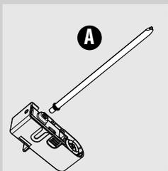
**4** Uklonite cijev usisa s priključkom (A) s elementa za tučenje mlijeka.
