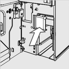
**17** Zatvorite ručku za zaprečivanje kako biste zapriječili sklop za ispuštanje.
