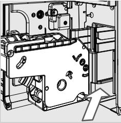
**16** Naslonite sklop za ispuštanje na vodilice i gurajte ga u ležište sve dok se ne zakvači.
