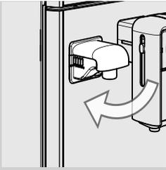
**2** Pritisnite i zakrenite ispušt vode prema dolje dok se ne zakvači na aparat kako je prikazano na slici.
