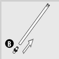
**13** Postavite priključak (B) na cijev usisa.
