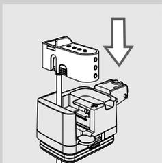
**6** Nakon što postavite cijev usisa s priključkom, umetnite ispuštivač vrča na gornji dio vrča.
