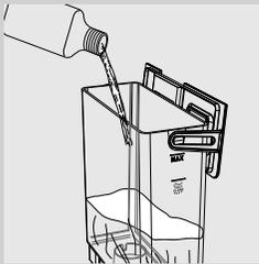
6 Uklonite spremnik vode i filter za vodu "INTENZA+" (ako je postavljen) i umetnite mali bijeli filter koji se isporučuje uz aparat. Uspite sav sadržaj sredstva za uklanjanje kamenca Saeco.
