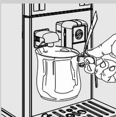
**8** Ispustite željenu količinu vruće vode. Pritisnite tipku "↶" kako biste prekinuli ispuštanje vruće vode.
