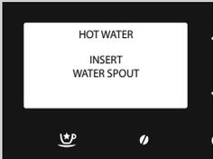
**6** Prikazuje se simbol koji je prikazan sa strane. Aparat zahtjeva ugradnju ispušta vode. Provjerite je li ispušt vode pravilno postavljen. Pritisnite "✓" kako biste potvrdili odabir. Aparat započinje ispuštati vruću vodu.
