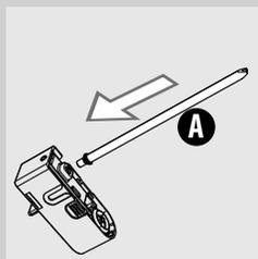
**14** Umetnite cijev usisa opremljenu priključkom (A) u element za tučenje mlijeka.
