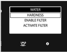
Pod stavkom **HARDNESS** možete programirati stupanj tvrdoće vode. Pogledajte poglavlje "Mjerenje i programiranje tvrdoće vode" kako biste se upoznali s postupkom mjerenja tvrdoće vode.
