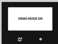
Aparat se isporučuje s prezentacijskim programom načina rada. Ako tipku "☺" držite pritisnutom više od osam sekundi, aparat prelazi u prezentacijski način rada. Izvucite kabel za napajanje iz utičnice i ponovno upalite aparat kako biste izašli iz prezentacijskog načina rada.
