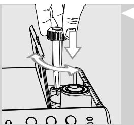
**2** Dok aparat melje, pritisnite i okrenite ručicu za podešavanje mljevenja koja se nalazi unutar spremnika kave u zrnu samo za jedan korak odjednom. Koristite ključ za podešavanje mlinca za kavu priložen uz aparat. Razlika u okusu bit će primijećena nakon ispuštanja 2-3 kave.
