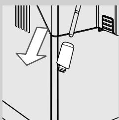
**16** Uklonite kromiranu oblogu s gumenom zaštitom s cijevi za paru.
