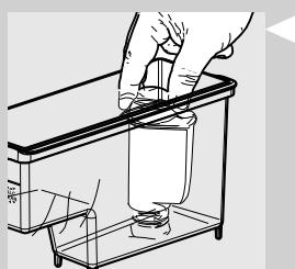
**18** Uklonite mali bijeli filter i vratite filter za vodu "INTENZA+" (ako postoji) u spremnik vode.
