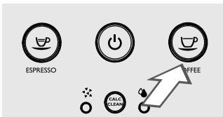
Aparat je u fazi programiranja količine jedne kave koju će ispustiti.
