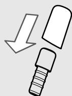
**17** Uklonite gumenu zaštitu s kromirane obloge.
