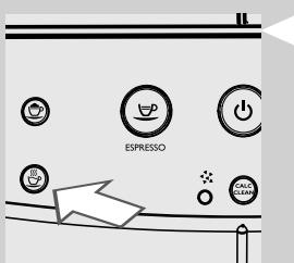
**5** Ispustite željenu količinu tople vode. Za prekid ispuštanja tople vode pritisnite tipku "끓이기".
