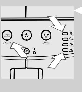
**2** Led lampice " $\Delta$ " i " $\triangle$ " trepere istovremeno, nakon toga se uključuje tipka " $\text{ESPRESSO}$ ".
