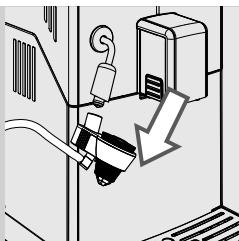
**2** Uklonite element za automatsko tučenje mlijeka s cijevi za paru/toplu vodu.
