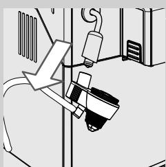
**15** Uklonite element za automatsko tučenje mlijeka s cijevi za paru.
