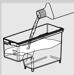
**3** Izvadite spremnik vode i izvadite filter za vodu "INTENZA+" (ako postoji) iz spremnika vode i zamijenite ga originalnim malim bijelim filterom.
