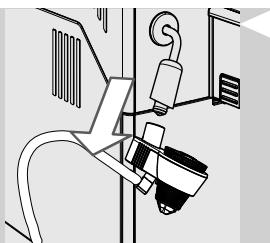
**1** Uklonite element za automatsko tučenje mlijeka s cijevi za paru.
