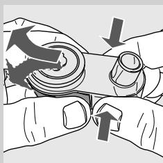
**19** Za rastavljanje elementa za automatsko tučenje mljeka pritisnite na bočne stranice i izvucite ga uz lagane pokrete bočno kao što je prikazano na slici.
