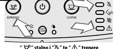
Aparat zahtijeva punjenje sustava. Pritisnite tipku "". Jednom kada se pritisne tipka se gasi. Tijekom punjenja sustava led lampice "<-->" i "" trepere i gase se po završetku punjenja.
