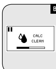
Ciklus uklanjanja naslaga kamenca (A) i ispiranja (B) mogu se staviti u pauzu pritiskom na taster ; da biste nastavili sa ciklusom, pritisnite taster . Time se omogućava praznjenje posude ili da se nakratko udaljite.
