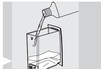
٤ ازّع خزان المياه وصب المحتوى بالكامل لنزار الكالسيوم Saeco. ثم املأ خزان الماء بالماء العذب إلى أن يصل إلى المستوى "MAX".
