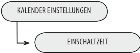
In diesem Menü können die Uhrzeiten für die Einschaltung der Maschine nach Ihren Anforderungen programmiert werden. Die Maschine steuert diese Funktion nur dann, wenn sie über den Hauptschalter eingeschaltet ist. Es können 3 unterschiedliche Einschaltzeiten programmiert werden, die unabhängig gesteuert werden. Der Einfachheit halber wird nur die Programmierung des "TIMER 1" beschrieben. Die anderen Timer werden in der gleichen Weise programmiert.
