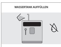
Den Wassertank herausnehmen und mit frischem Trinkwasser füllen oder über die entsprechende Öffnung nachfüllen.
