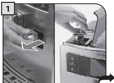
Die Schutzabdeckung der Maschine abnehmen und an einem sauberen Ort aufbewahren. Es wird empfohlen, diese in die Aufnahme des Wasserdeckels einzulegen.
