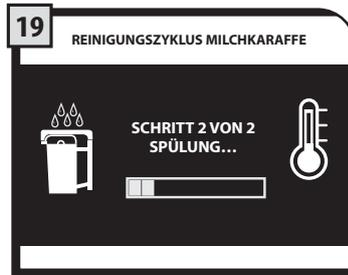
Der Spülzyklus wird gestartet. Anhand der Leiste kann der Fortschritt des Vorgangs angezeigt werden. Nach Beendigung des Zyklus kehrt die Maschine auf die Seite für die Produktausgabe zurück.
