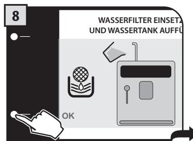
Die Taste "OK" drücken, um den Einsatz des neuen Wasserfilters zu bestätigen.
