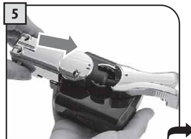
Die äußere Abdeckung einsetzen. Diese muss in die Führungen der Basis eingesetzt werden.
