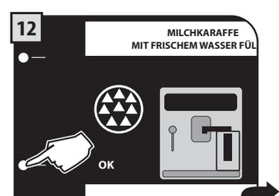
Die Karaffe vollständig leeren (S. 38 - Abb. 7) und mit frischem Wasser füllen. Die Karaffe einsetzen und für die Ausgabe positionieren.
