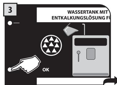
Den Tank mit Entkalkungslösung füllen. Bestätigen, indem die Taste "OK" gedrückt wird.
