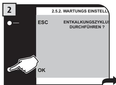
Achtung: wird diese Auswahl bestätigt, muss der gesamte Zyklus abgeschlossen werden. Bestätigen, indem die Taste "OK" gedrückt wird, oder abbrechen, indem die Taste "ESC" gedrückt wird.
