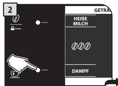
2 Die Taste drücken und abwarten, bis die programmierte Dampfmenge ausgegeben wird.
