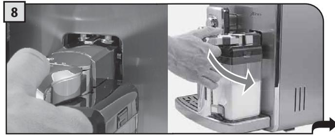
Die Karaffe mit einer Dreh- und Schubbewegung nach unten (wie in der Abbildung gezeigt) einsetzen, bis der Einsatz (E) auf der Abtropfschale einrastet.
