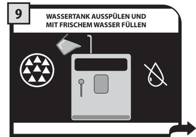
Nach Beendigung der ersten Phase fordert die Maschine zur Spülung des Tanks auf, wenn kein Entkalker mehr vorhanden ist.
