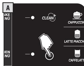
Befindet sich die Maschine im "Standby", blinkt die rote Kontrolllampe.
