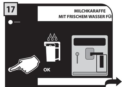
Die Karaffe abnehmen, ausspülen und mit frischem Trinkwasser füllen. Bestätigen, indem die Taste "OK" gedrückt wird.
