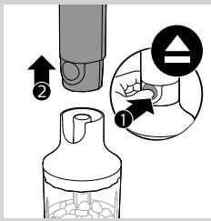
**8** Pritisnite dugme za otpuštanje da biste uklonili jedinicu motora sa poklopca seckalice.
