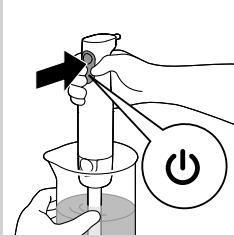
**5** Uključite aparat pritiskom na dugme za uključivanje/isključivanje.
