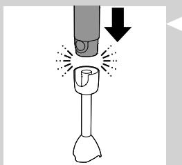
**1** Stavite cilindrični blender na jedinicu motora („klik“).
