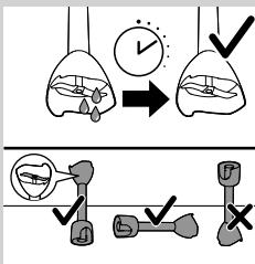
**10** Postavite cilindrični blender u uspravan položaj, tako da zaštita sečiva bude gore, pa ga ostavite da se suši bar 10 minuta pre nego što ga odložite.
