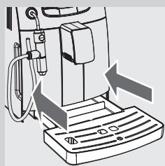
**4** Introduceți în aparat cuva de colectare a picăturilor, prevăzută cu tăviță. Verificați dacă este introdusă până la capăt.
