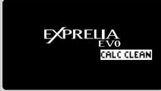
Con el uso, en el interior de la máquina se forma cal, la cual debe ser eliminada con regularidad; en caso contrario, el circuito hídrico y de café pueden obstruirse. Cuando sea necesario proceder a la descalcificación, la máquina lo señalará.
