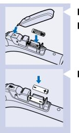
8 拆下電池室蓋板並將電池壓回正確位置。
