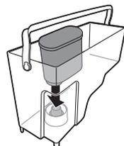
**17** Filtr AquaClean vložte svisle na připojení filtru. Zatlačte filtr AquaClean do nejnižší možné polohy. Aby byl zajištěn co nejlepší výkon, filtr musí lehce zapadnout na místo a těsnění musí být ve správné poloze.
