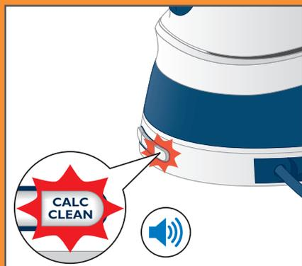
Détartrez votre appareil lorsque le voyant de détartrage clignote et que l'appareil émet des signaux sonores.
