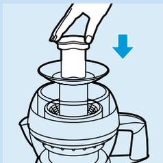
A készülék csak akkor működik, ha a kancsót és a fedőt megfelelően helyezte fel a motoregységre.
