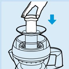
Aparatul va funcționa doar dacă vasul și capacul au fost poziționate corect pe unitatea motorului.
