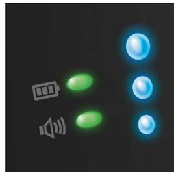
Compruebe que el monitor está conectado. Una luz verde indica que está conectado, una luz roja parpadeante indica que se ha perdido la conexión
