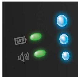
Überprüfen Sie die Monitorverbindung. Ein grünes Licht zeigt an, dass eine Verbindung besteht, ein rotes Blinklicht dagegen, dass die Verbindung getrennt wurde.
