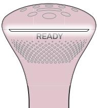
**6** Proverite da li indikator „SPREMNO za emitovanje“ svetli belom bojom, što znači da je aparat u potpunom dodiru sa kožom.
