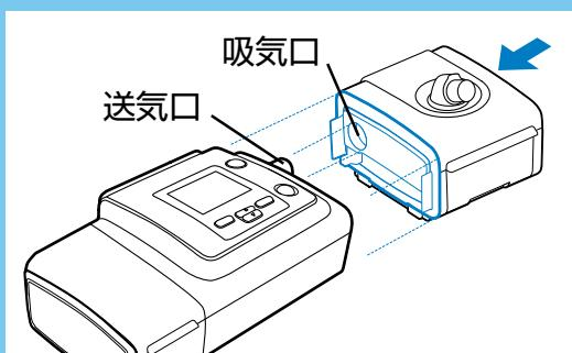
機器本体の送気口と加温加湿器の吸気口が重なるように並べ、カチッと音がするまで押し合わせます。
