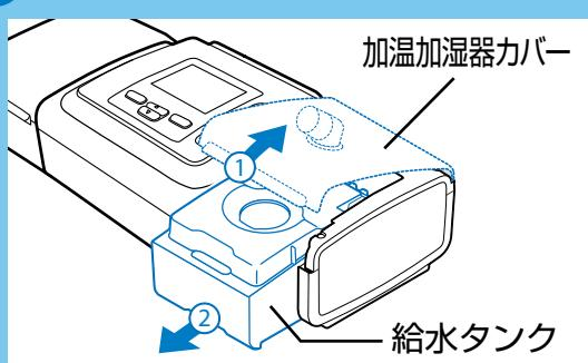
加温加湿器のカバーを図の様に上げ、水タンクを引き出します。
