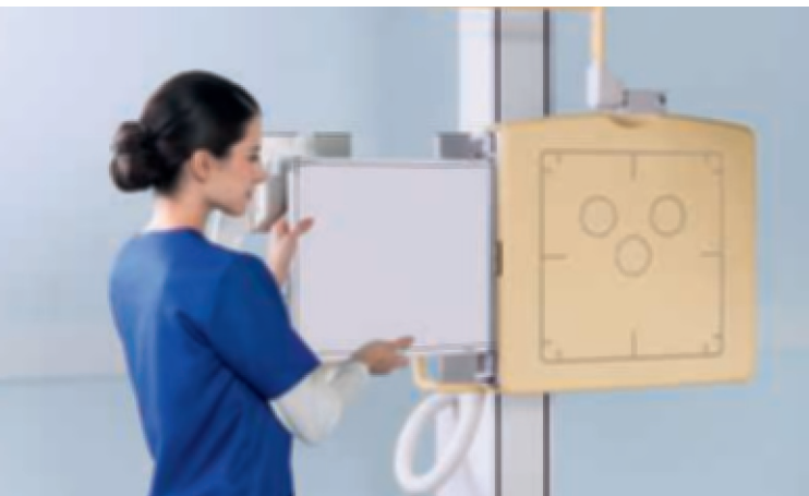
Thorax, Patient stehend (PA) Detektor in Detektorlade des Wandstativs eingesetzt
