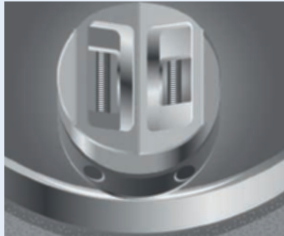
Kathodenkopf mit den zwei Glühfäden einer Doppelfokusröhre
