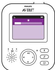
Bara de luminozitate va apărea pe afișaj pentru a indica nivelul de luminozitate al afișajului selectat.
