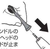
ブラシヘッドの毛先がハンドルの正面を向くように、ブラシヘッドの向きをそろえ、ブラシヘッドが止まるまで金属シャフトにヘッドをしっかりと差し込んで取り付けます。
