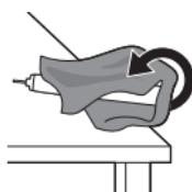
**3.** 片手でハンドルの上部を持ち、ハンドルの底から約1.5cmの位置をハンマーで叩きます。ハンドルを回転させながら、四方向から強く叩いて底のキャップを外します。
