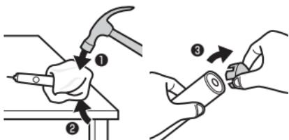
3. ハンドル下部を叩いて外部カバーを壊し(①)、充電池ホルダーを引き抜きます(②)。
