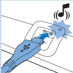
► När du ansluter BlueTouch-smärtlindringsplattan till elnätet pipar den en gång så att du vet att laddningen startar. Laddningslampan på anslutningspanelen blinkar långsamt och regelbundet med ett grönt sken under laddning.
