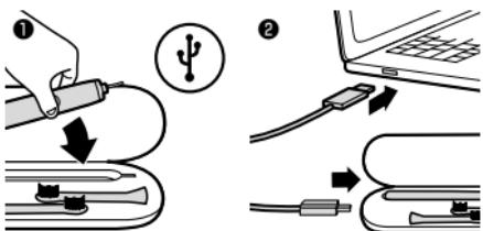
2. USB端子が通電していると、充電インジケーターが点灯します。
