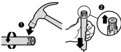
2. ハンドルを布で包み表面の頑丈な場所に置き、ハンドルの底から2センチの位置をハンマーで軽く叩きます(①)。ハンドルを90度回転させ(②)、底のキャップが外れるまで(③)繰り返します。
