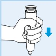
Schrauben Sie die Unterseite des Grundgeräts gegen den Uhrzeigersinn ab.
