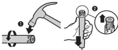
2. ハンドルを布で包み表面の頑丈な場所に置き、ハンドルの底から2センチの位置をハンマーで軽く叩きます(1)。ハンドルを90度回転させ(2)、底のキャップが外れるまで1②を繰り返します。底のキャップを外します(3)。
