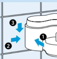
**I** Прикріпіть зарядний пристрій до стіни, застосовуючи 2 шурупи (3,0 x 30 мм) та 2 стінних кронштейна (S5, не додаються).
