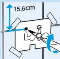
**I** Навесьте зарядное устройство на стену с помощью 2 винтов (3,0x30 мм) и 2 пробок (S5) (в комплект поставки не входят).
