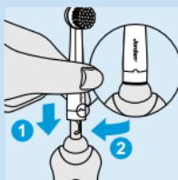
**3** Setzen Sie den Bürstenaufsatz auf die Zahnbürste wie in der Abbildung gezeigt (Bajonettverschluß).
