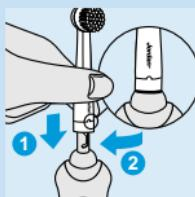
**3** Placez la tête de brosse sur la brosse à dents en l'insérant dans le raccord à baïonnette et en la faisant tourner.
