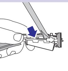
4. Įdėkite atsuktuvą po plokštele, prie baterijos sujungimų ir pasukite, norėdami nutraukti sujungimus. Išimkite plokštelę ir ištraukite bateriją iš plastikinio dėkliuko.
