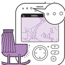
Gdy nadajnik wykryje jakiś dźwięk, jeden lub więcej wskaźników poziomu dźwięku zacznie świecić na zielono. Liczba włączonych wskaźników zależy od głośności dźwięku wychwyconego przez nadajnik. Im głośniejsze dziecko płacze, tym więcej wskaźników poziomu dźwięku świeci na zielono.
