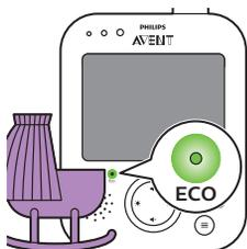
W przypadku wykrycia dźwięku przez nadajnik ekran i dźwięk w odbiorniku są natychmiast włączane. Dźwięki są przekazywane do odbiornika, a wskaźniki poziomu dźwięku świecą na zielono. Dopóki nadajnik nie wykrywa żadnego dźwięku, wskaźniki poziomu dźwięku nie świecą się.
