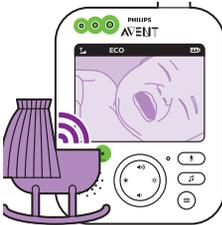
Kada jedinica za bebu zabeleži neki zvuk, ekran i zvuk na roditeljskoj jedinici se odmah uključuju. Zvukovi se prenose na roditeljsku jedinicu i svetla za nivo zvuka svetle zeleno. Sve dok se zvuk ne detektuje, svetla za nivo zvuka su isključena.
