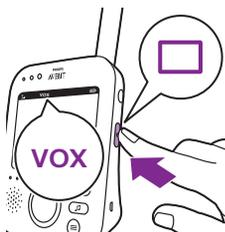
Po aktywowaniu trybu VOX, wyświetlacz i dźwięki odbiornika są wyłączane, jeśli przez 20 sekund nie zostanie wykryty żaden dźwięk.
