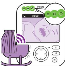
Kada jedinica za bebu uhvati neki zvuk, jedno ili više svetala za nivo zvuka na roditeljskoj jedinici zasvetle zeleno. Broj svetala koja će da zasvetle zavisi od glasnoće zvuka koju uhvati jedinica za bebu. Što glasnije beba plače, to će veći broj svetala za nivo zvuka zasvetliti zeleno.
