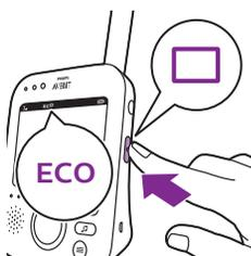
Po aktywowaniu trybu ECO wyświetlacz i dźwięki odbiornika są wyłączane, jeśli przez 20 sekund nie zostanie wykryty żaden dźwięk. Jeśli wskaźnik ECO świeci na zielono, oznacza to, że tryb ECO jest aktywny. W trybie ECO transmisja obrazu i dźwięku jest wyłączona.
