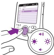
Ko se premikate med menijskimi funkcijami in ne želite shraniti nobene spremembe, pritisnite menijski gumb. Meni boste zapustili brez spreminjanja nastavitev.
