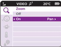
3 Για να προσαρμόσετε την προβαλλόμενη εικόνα, πατήστε το δεξιό τμήμα του κουμπιού ελέγχου. Τώρα, μπορείτε να χρησιμοποιήσετε το πάνω/κάτω/δεξιό/αριστερό τμήμα του κουμπιού ελέγχου, για να επιλέξετε την εικόνα που θα προβάλλεται στη μονάδα γονέα.
