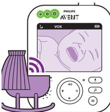
Ako beba plače, svetla za nivo zvuka će zasvetliti zeleno. Sve dok se zvuk ne detektuje, svetla za nivo zvuka su isključena.
