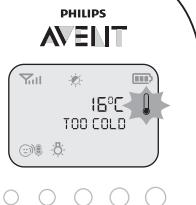
Se la temperatura è al di sotto o al di sopra dell'intervallo impostato, il simbolo di allarme della temperatura sul display ha solo una tacchetta e lampeggia. Il messaggio "TOO COLD" (TROPPO FREDDO) o "TOO HOT" (TROPPO CALDO) appare sul display.
