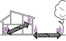
Çalışma menzili dış mekanda 50 metre /165 feet, iç mekanlarda ise ve 300 metre / 985 feet'tir. Bebek monitörünün çalışma menzili ortama ve parazit oluşturan faktörlere bağlı olarak değişiklik gösterir. Islak ve nemli malzemeler menzil kaybının %100'e varmasına neden olacak kadar yüksek parazit oluşturur.
