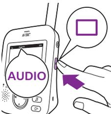
1 Drücken Sie die Modus-Taste an der Elterneinheit, um in den AUDIO-Modus zu wechseln.
