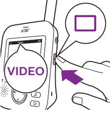
VIDEO modunu seçmek için ebeveyn ünitesinin kenarındaki mod düğmesine basın.
