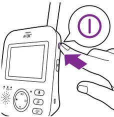
4 Tryk på tænd/sluk-knappen på forældreenheden for at tænde forældreenheden.
