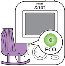
Kun ECO-tila on käytössä, vanhemman yksikön näyttö ja äänet poistetaan käytöstä, jos ääniä ei havaita 20 sekuntiin. ECO -valo palaa vihreänä, kun ECO-tila on käytössä. ECO-tilassa ei lähetetä kuvaa tai ääntä.
