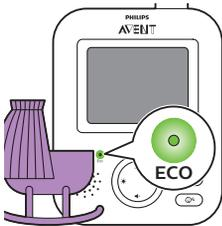
Når ECO-modus er aktiveret, slukkes displayet og lydene på forældreenheden, hvis der ikke registreres nogen lyde i 20 sekunder. ECO-indikatoren lyser grønt for at angive, at ECO-modus er aktiveret. Når ECO-modus er aktiveret, er display- og lydtransmissionerne slukket.
