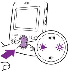
Potete regolare la luminosità del display dell'unità genitore sul livello desiderato.
