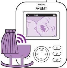
**Hinweis:** Die Verbindungsanzeige zeigt, dass die Elterneinheit eingeschaltet und mit der Babyeinheit verbunden ist.
