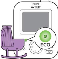
La pantalla y el sonido de la unidad de padres se apagan cuando no se detecta sonido durante 20 segundos. El piloto ECO se ilumina en verde para indicar que el modo ECO está activado. Durante el modo ECO se apagan la pantalla y las transmisiones de sonido.
