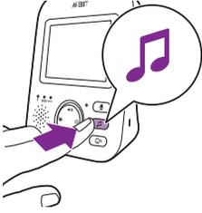
1 Pulse el botón de nanas en la unidad de padres para abrir el menú de nanas. Pulse la parte izquierda del botón de control y, después, la parte inferior para seleccionar las opciones de volumen del menú de nanas. Pulse la parte derecha del botón de control para acceder a los niveles de volumen de las nanas.
