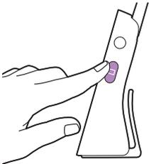
Cet écoute-bébé propose quatre modes qui vous permettent de choisir la méthode utilisée pour surveiller votre bébé : VIDEO, AUDIO, VOX et ECO. Lorsque l'écoute-bébé est allumé, vous pouvez basculer entre ces 4 modes en appuyant sur le bouton de mode sur le côté de l'unité-parents. L'afficheur indique le mode sélectionné. Le mode sélectionné est également indiqué dans la barre d'état. Lorsque vous allumez l'appareil, le dernier mode utilisé est actif.
