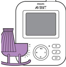
Das Display der Elterneinheit wird ausgeschaltet, der AUDIO-Modus ist jedoch aktiviert. 3 Sekunden nach dem Auswählen des AUDIO-Modus wird das Display ausgeschaltet.
