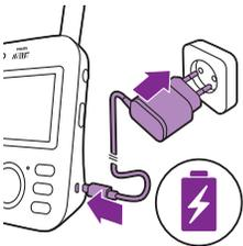
L'unità genitore funziona con una batteria ricaricabile agli ioni di litio incorporata.
