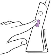
Bebek monitörü açık olduğunda, ebeveyn ünitesinin kenarındaki mod düğmesine basarak bu 4 farklı mod arasında geçiş yapabilirsiniz. Ekranda seçili mod görüntülenir. Seçilen mod durum çubuğunda gösterilir. Cihazı çalıştırırken en son kullanılan mod etkinleşecektir.
