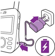
La unidad de padres usa una batería de iones de litio recargable integrada. Siga estos pasos para cargar la unidad de padres:
