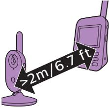
3 Se till att enheterna är placerade minst 2,5 meter ifrån varandra för att undvika att rundgång uppstår.
