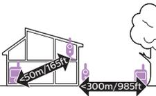
La portata di funzionamento è di 50 m in interno e fino a un massimo di 300 m in esterno. La portata di funzionamento del baby monitor varia a seconda dell'ambiente circostante e dei fattori che causano interferenze. I materiali bagnati e umidi causano un'interferenza tale da ridurre la portata fino al 100%.
