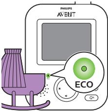
Das Display und die Tonausgabe der Elterneinheit werden ausgeschaltet, wenn für 20 Sekunden kein Geräusch erkannt wird. Die ECO-Anzeige leuchtet durchgehend grün und zeigt an, dass der ECO-Modus aktiviert ist. Im ECO-Modus sind das Display und die Tonübertragung ausgeschaltet.
