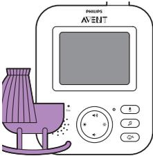
Wanneer de AUDIO-modus wordt geactiveerd, wordt de display van de ouderunit uitgeschakeld. Na 3 seconden wordt het display volledig uitgeschakeld en verdwijnt de statusbalk.
