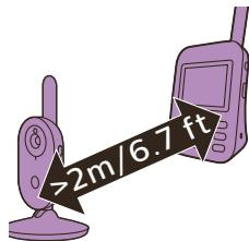
**3** Se till att enheterna är placerade minst 2,5 meter ifrån varandra för att undvika att rundgång uppstår.
