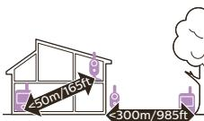
O alcance de funcionamento é até 50 metros no interior e até 300 metros / no exterior. O alcance de funcionamento do intercomunicador para bebé varia consoante a área circundante e fatores que provoquem interferência. Materiais molhados e húmidos causam tanta interferência que a perda de alcance pode atingir os 100 %.
