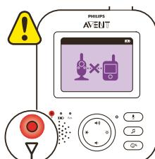
**Nota:** sono necessari meno di 10 secondi per stabilire il collegamento tra l'unità genitore e l'unità bambino.
