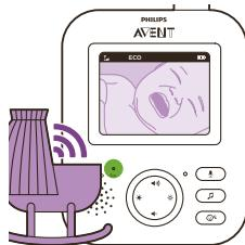
Wenn ein Geräusch von der Babyeinheit entdeckt wird, werden das Display und die Tonausgabe der Elterneinheit sofort eingeschaltet. Die Geräusche werden an die Elterneinheit übertragen.
