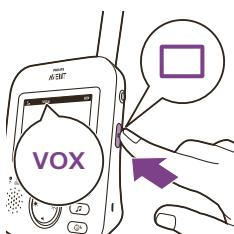
Quando o modo VOX (Voz) é ativado, o visor e o som da unidade dos pais desligam-se, se não for detetado som durante 20 segundos.
