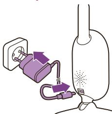
Steek de kleine stekker in de babyunit en steek de netspanningsadapter in een stopcontact.
