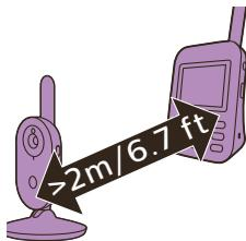
**3** Varmista, että lapsen yksikön ja vanhemman yksikön välinen etäisyys on vähintään 2,5 metriä. Näin vältät kaikuefektiin.
