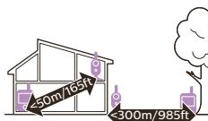
Driftsrekkevidden er opp til 50 meter innendørs og opp til 300 meters utendørs. Driftsrekkevidden til babymonitoren varierer avhengig av omgivelsene og faktorer som forårsaker forstyrrelser. Våte og fuktige materialer forårsaker så store forstyrrelser at tapet av rekkevidde er opp til 100 %.
