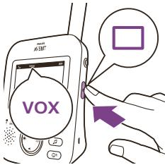
Quando la modalità VOX è attivata, il display e l'audio dell'unità genitore si disattivano se non viene rilevato alcun suono entro 20 secondi..
