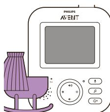
Quando la modalità AUDIO è attivata, il display dell'unità genitore si spegne. Dopo 3 secondi il display si spegnerà completamente e la barra di stato scomparirà.
