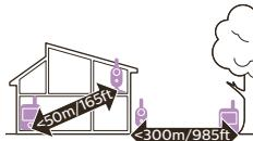
Der Betriebsbereich beträgt bis zu 50 Meter im Innenbereich und 300 Meter im Außenbereich. Die Reichweite des Babysphones ist von der Umgebung und von eventuellen Störfaktoren abhängig. Nasse und feuchte Materialien können die Reichweite um bis zu 100 % verringern.
