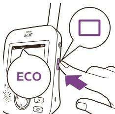
Wanneer de ECO-modus is geactiveerd, worden het display en het geluid van de ouderunit uitgeschakeld als er gedurende 20 seconden geen geluid wordt gedetecteerd. Het ECO-lampje brandt om aan te geven dat de ECO-modus is geactiveerd. In de ECO-modus worden er geen beeld en geluid doorgegeven.
