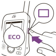
Kun ECO-tila on käytössä, vanhemman yksikön näyttö ja äänet poistetaan käytöstä, jos ääniä ei havaita 20 sekuntiin. ECO -valo palaa vihreänä, kun ECO-tila on käytössä. ECO-tilassa ei lähetetä kuvaaa tai ääntä.
