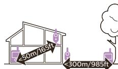
La portée va jusqu'à 50 mètres à l'intérieur et 300 mètres / à l'extérieur. La portée de l'écoute-bébé varie en fonction de l'environnement et d'autres facteurs à l'origine d'interférences. Pour les interférences provoquées par des objets humides, la perte de portée peut être totale.
