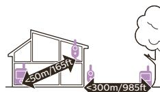
El alcance de funcionamiento es de hasta 50 metros en interiores y de hasta 300 metros en exteriores. El alcance de funcionamiento del vigilabebés varía en función del entorno y de los factores que provocan interferencias. Los materiales mojados y húmedos provocan tantas interferencias que la pérdida de alcance puede ser de hasta el 100 %.
