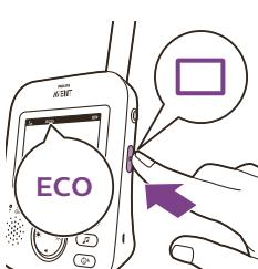
Quando la modalità ECO è attivata, il display e l'audio dell'unità genitore si disattivano se non viene rilevato alcun suono entro 20 secondi. La spia ECO emette un colore verde per indicare che la modalità ECO è attivata. Durante la modalità ECO le trasmissioni del display e dell'audio sono disattivate.
