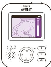
**2** Appuyez sur la partie inférieure ou supérieure du bouton de commande pour sélectionner le niveau de sensibilité souhaité.
