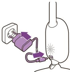
Stecken Sie den Netzstecker in die Babyeinheit und den Adapter in die Steckdose.
