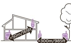
Çalışma menzili dış mekanda 50 metre /165 feet, iç mekanlarda ise ve 300 metre / 985 feet'tir. Bebek monitörünün çalışma menzili ortama ve parazit oluşturan faktörlere bağlı olarak değişiklik gösterir. İslak ve nemli malzemeler menzil kaybının %100'e varmasına neden olacak kadar yüksek parazit oluşturur.
