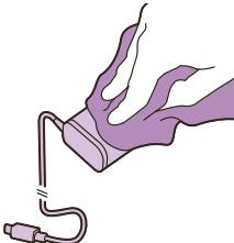
**5** Reinigen Sie die Adapter mit einem trockenen Tuch.
