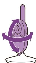
Ajuste a unidade do bebé de forma a assegurar a melhor visibilidade do seu bebé. É possível rodar a unidade do bebé para a colocar na posição pretendida.
