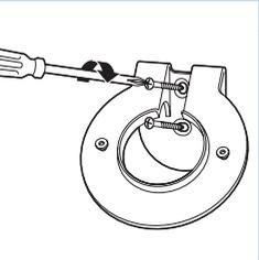
5 Gebruik 2 schroeven om de beugel voor wandmontage aan de wand te bevestigen. Zet de schroeven met een schroevendraaier vast.
