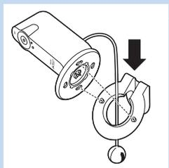
6 Faites passer le capteur d'humidité et de température dans l'orifice du support de montage mural. Alignez ensuite les fentes du pied de l'écoute-bébé avec les parties saillantes de l'anneau. Adaptez la rainure du pied de l'écoute-bébé sur le bord surélevé à l'intérieur de l'anneau.
