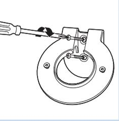
5 Utilice dos tornillos para fijar el soporte de montaje en pared. Apriete los tornillos con un destornillador.
