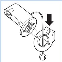
6 Passate l'unità sensore di umidità e temperatura attraverso il foro della staffa per montaggio a parete. Quindi, allineate le fessure presenti nella base del baby monitor con le sporgenze dell'anello. Inserite la scanalatura presente nella base del baby monitor sopra il bordo in rilievo all'interno dell'anello.
