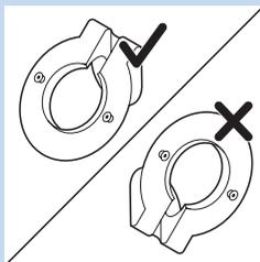
**Nota:** Asegúrese de que el anillo del soporte de montaje en pared queda inclinado hacia abajo cuando lo sujeta contra la pared. Si el anillo del soporte de montaje en pared queda inclinado hacia arriba, gire el soporte de montaje en pared al revés, de modo que esté en la posición correcta.
