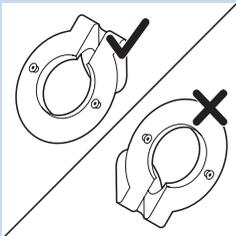
**Nota:** Certifique-se de que o anel do suporte de montagem na parede está inclinado para baixo quando o segura contra a parede. Se o anel do suporte de montagem na parede estiver inclinado para cima, volte o suporte de montagem na parede ao contrário de modo colocá-lo na posição correcta.
