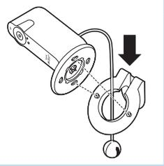
6 Pase la unidad de sensor de humedad y temperatura a través del orificio del soporte de montaje en pared. A continuación, alinee las ranuras de la base del vigilabebés con los salientes del anillo. Encaje la ranura de la base del vigilabebés con el borde saliente del interior del anillo.
