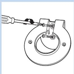
5 Utilisez 2 vis pour fixer le support de montage mural au mur. Serrez les vis à l'aide d'un tournevis.
