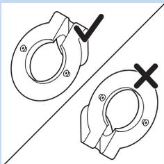
**Nota:** quando tenete premuta la staffa per il montaggio a parete, verificate che l'anello sia rivolto verso il basso. Se è rivolto verso l'alto, ruotate la staffa fino a portarla nella posizione corretta.
