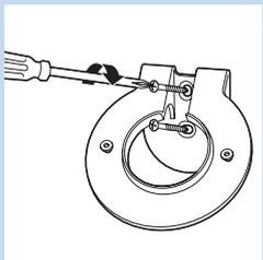
5 Utilize 2 parafusos para fixar o suporte de montagem na parede. Aperte os parafusos com uma chave de fendas.
