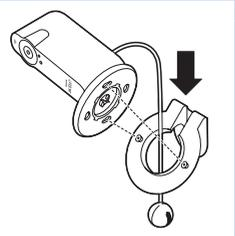
6 Voer de vochtigheids- en temperatuursensorunit door het gat in de beugel voor wandmontage. Lijn de sleuven in de voet van de babyfoon met de uitsparingen op de ring uit. Pas de groef in de voet van de babyfoon op de opstaande rand aan de binnenzijde van de ring.
