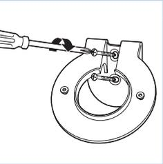
5 Verwenden Sie zwei Schrauben, um die Wandhalterung an der Wand zu befestigen. Ziehen Sie die Schrauben mit einem Schraubendreher fest.
