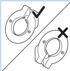
**Opmerking:** Zorg ervoor dat de ring van de beugel voor wandmontage omlaag helt als u deze tegen de wand houdt. Als de ring van de beugel voor wandmontage omhoog helt, draait u de beugel voor wandmontage om zodat deze zich in de juiste stand bevindt.
