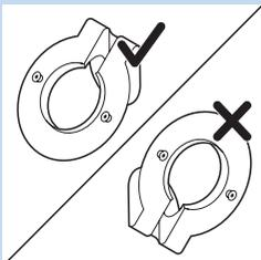
**Hinweis:** Stellen Sie sicher, dass der Ring der Wandhalterung nach unten geneigt ist, wenn Sie sie an die Wand halten. Wenn der Ring der Wandhalterung nach oben geneigt ist, drehen Sie die Wandhalterung um, sodass sie sich in der richtigen Position befindet.
