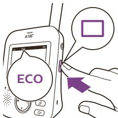
Kad je aktiviran način rada ECO, zaslon i zvuk roditeljske jedinice isključiti će se ako se tijekom 20 sekundi ne otkrije zvuk. Indikator ECO zasvijetli zeleno kako bi se naznačilo da je aktiviran način rada ECO. Dok je uređaj u načinu rada ECO, prijenos prikaza i zvuka je isključen.
